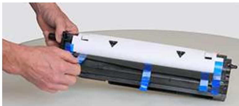
3. Снимите оранжевые фиксаторы с узла формирования изображения.
