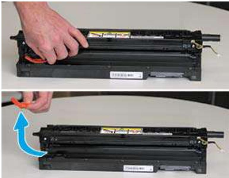
**⚠ ПРЕДУПРЕЖДЕНИЕ.** После снятия вставки узла формирования изображений следует держать ровно. Содержимое может просыпаться при наклоне узла формирования изображения.
