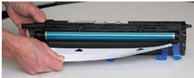
**⚠ ПРЕДУПРЕЖДЕНИЕ.** Не касайтесь поверхности роликов открытого барабана.
