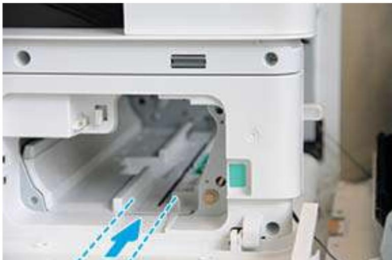
**⚠ ПРЕДУПРЕЖДЕНИЕ.** Не касайтесь поверхности роликов открытого барабана.
