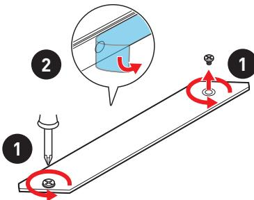
3. 請依照 M.2 SSD 的長度來移動 M.2 螺柱並鎖上，或如果您 M.2 SSD 長度與 M.2 散熱片一樣長，請移除 M.2 螺柱以保護 M.2 SSD 設備。
