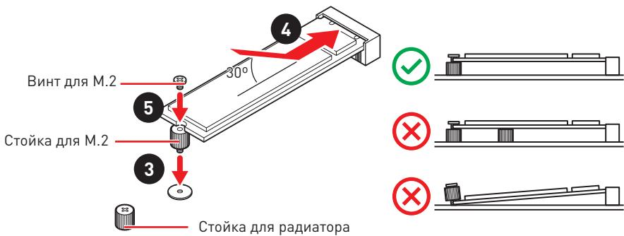
6. Установите на место радиатор M.2 SHIELD FROZR и закрепите его.
